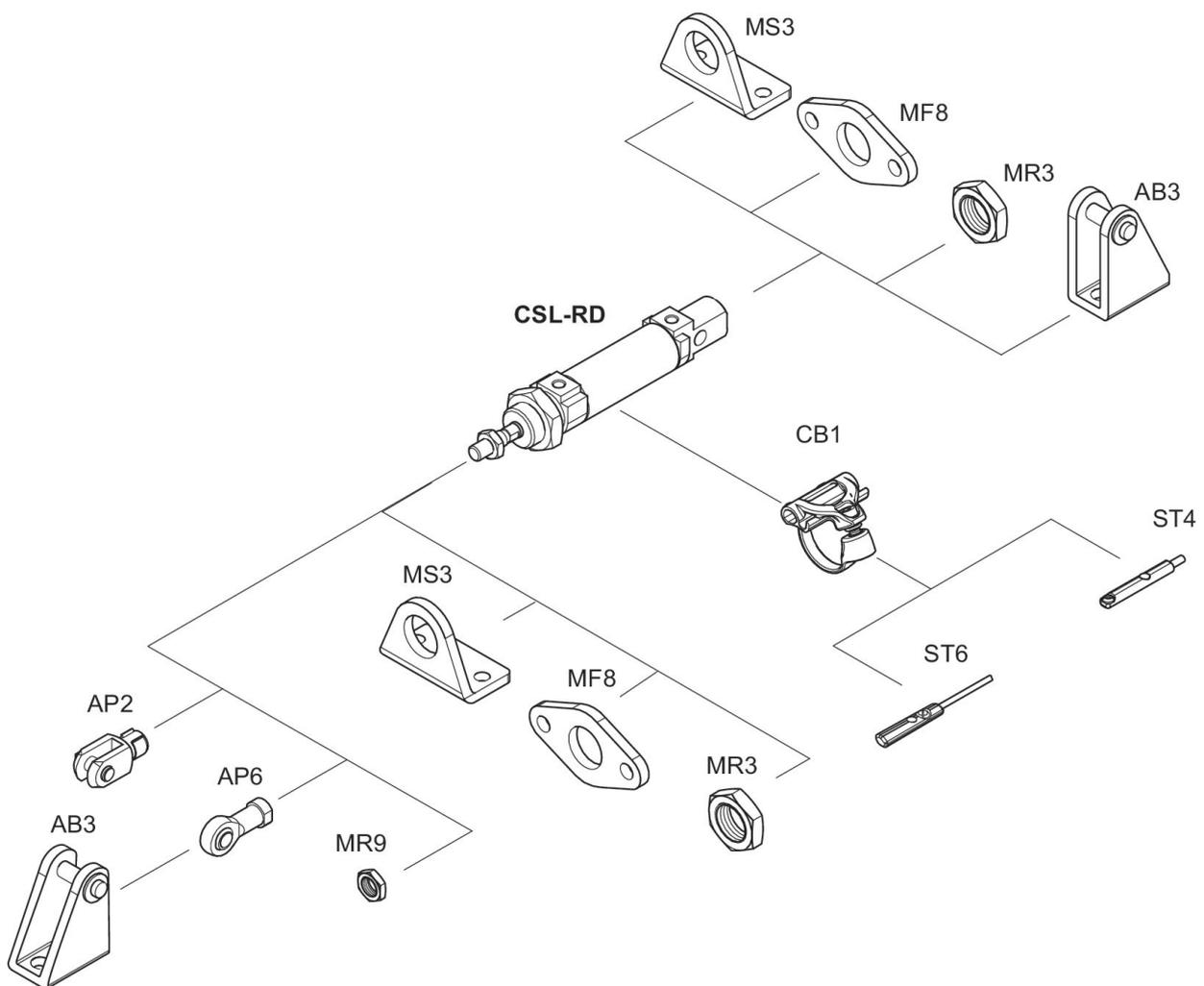
HINWEIS: Diese Übersichtszeichnung dient zur Orientierung, an welcher Stelle die unterschiedlichen Zubehörteile am Zylinder befestigt werden können. Dazu wurde die Darstellung vereinfacht. Eine konkrete Ableitung maßlicher Gegebenheiten ist deshalb nicht zulässig.
