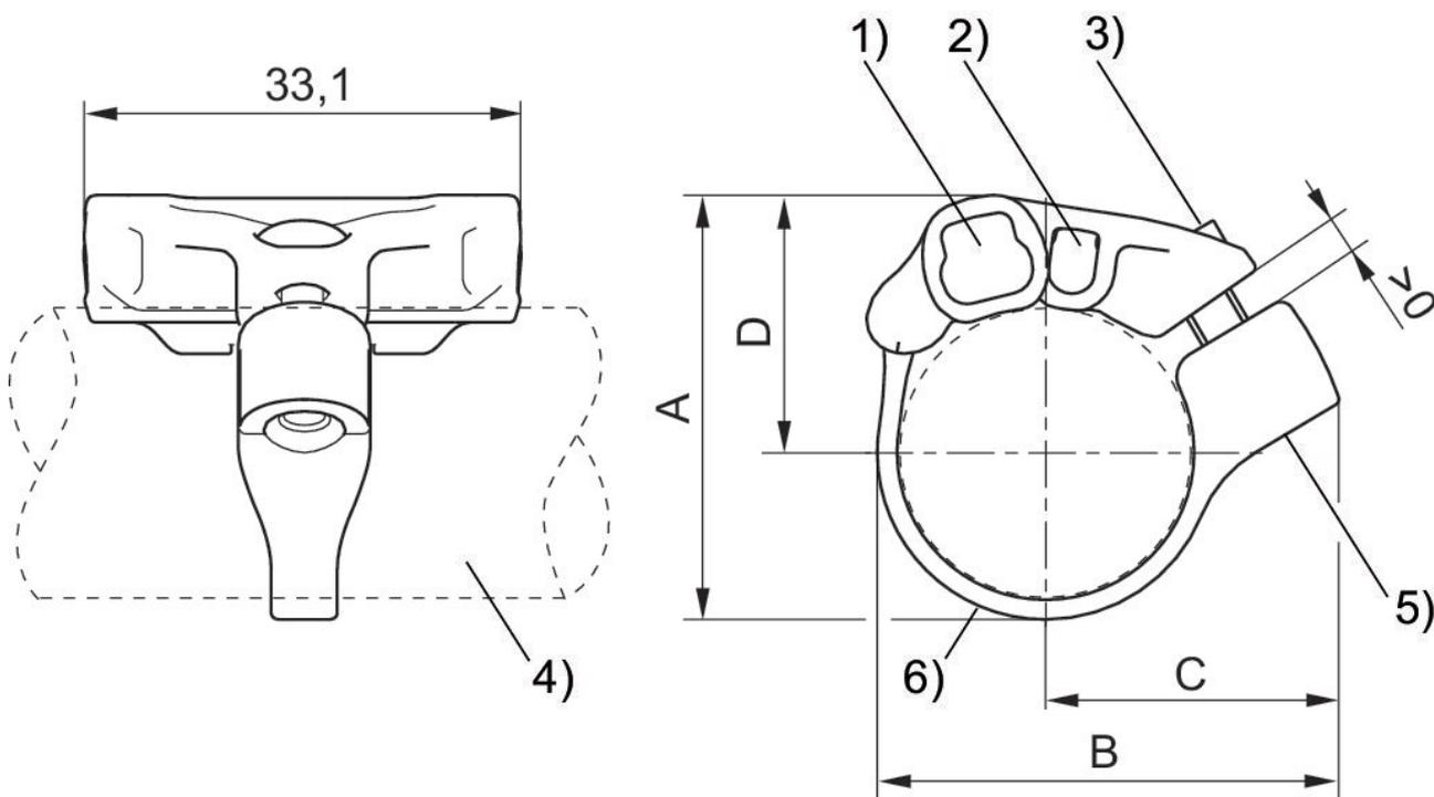
1) Scanalatura sensore per ST6 2) Scanalatura sensore per ST4 3) Vite di fissaggio (in acciaio inossidabile) 4) Profilato cilindro 5) Inserto filettato (in acciaio inossidabile) 6) Fascetta regolabile
