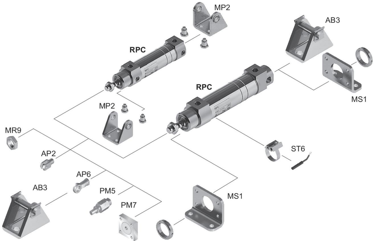
NOTA: Questo disegno di riepilogo serve da orientamento per il punto di fissaggio dei diversi accessori al cilindro. Per questo l'illustrazione è stata semplificata. Non sono consentite deduzioni concrete di dati di misurazione.
