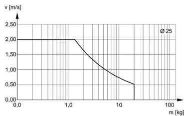
$v$  = Kolbengeschwindigkeit [m/s]  $m$  = Dämpfbare Masse [kg]
