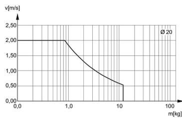
$v_t$  = Velocidad del pistón [m/s]  $m$  = Masa amortiguada [kg]
