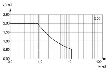
$v$  = ピストン速度 [m/s]  $m$  = 緩衝可能質量 [kg]
