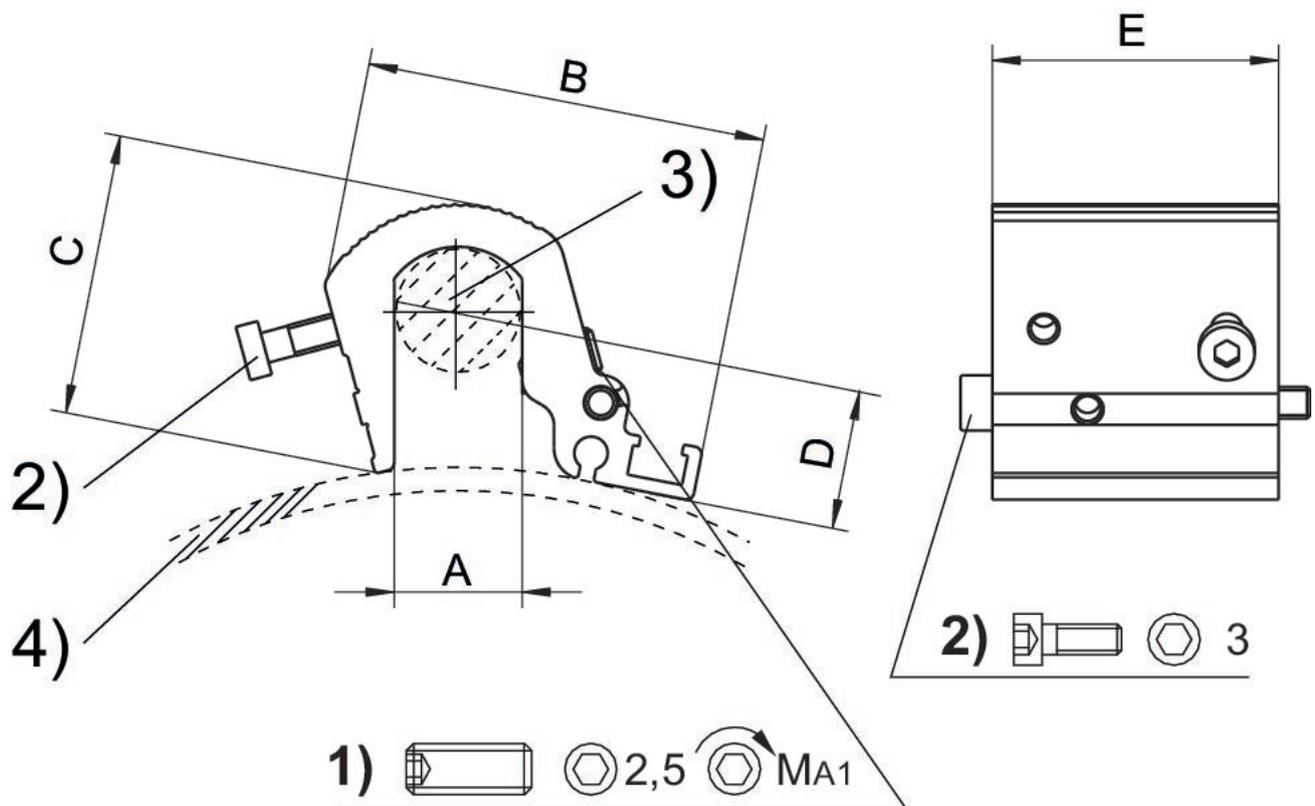
1) Prigioniero di fissaggio 2) Viti di fissaggio per il sensore 3) Tirante 4) Profilato cilindro
