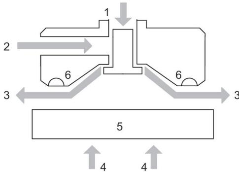
1) Druckluftanschluss 2) alternativer Druckluftanschluss 3) Luftstrom 4) Hubkraft 5) Objekt 6) Anschlag
