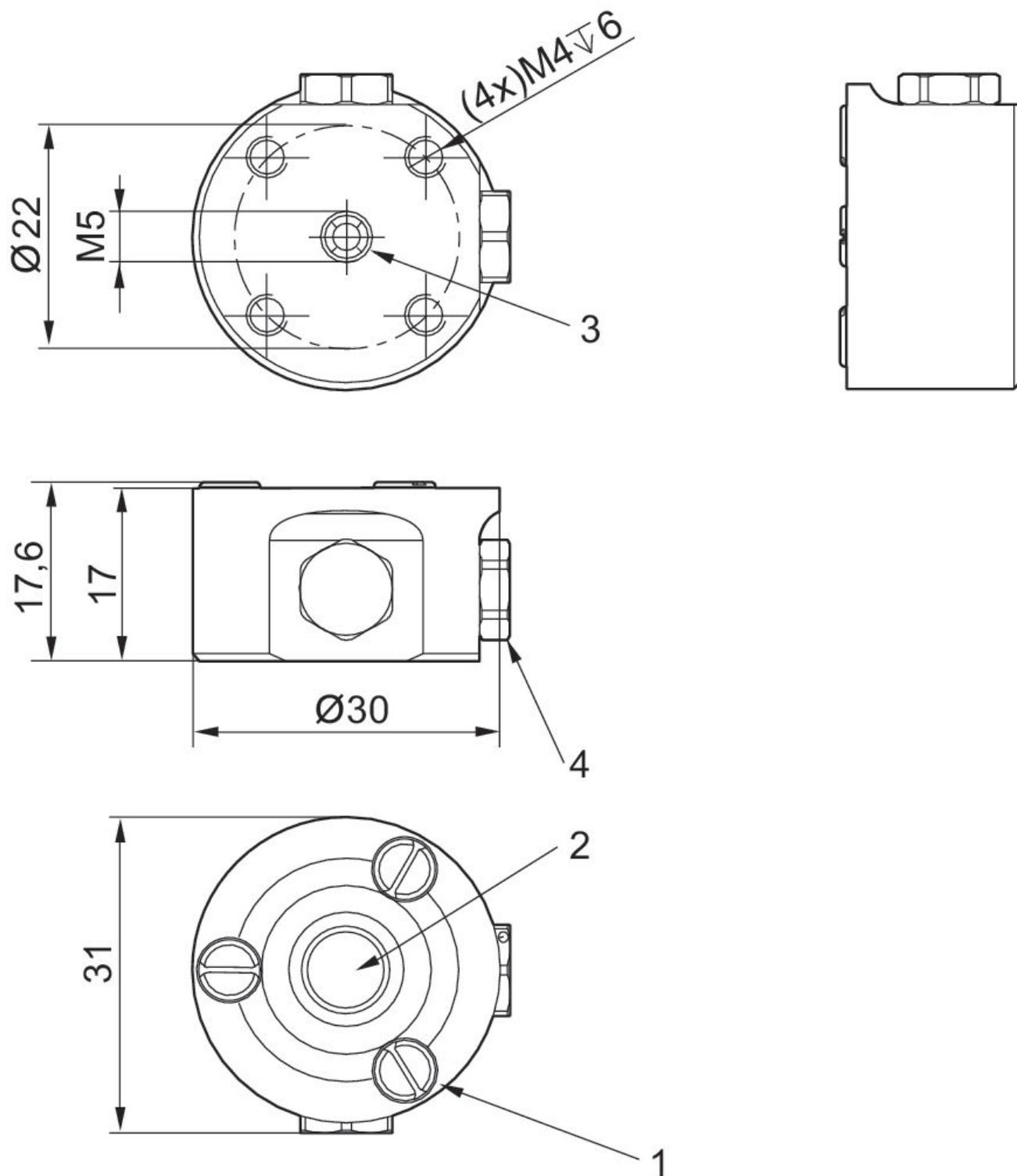
1) 停止 2) ノズル 3) 圧縮空気ポート 4) 封ねじ付きその他の圧縮空気ポート
