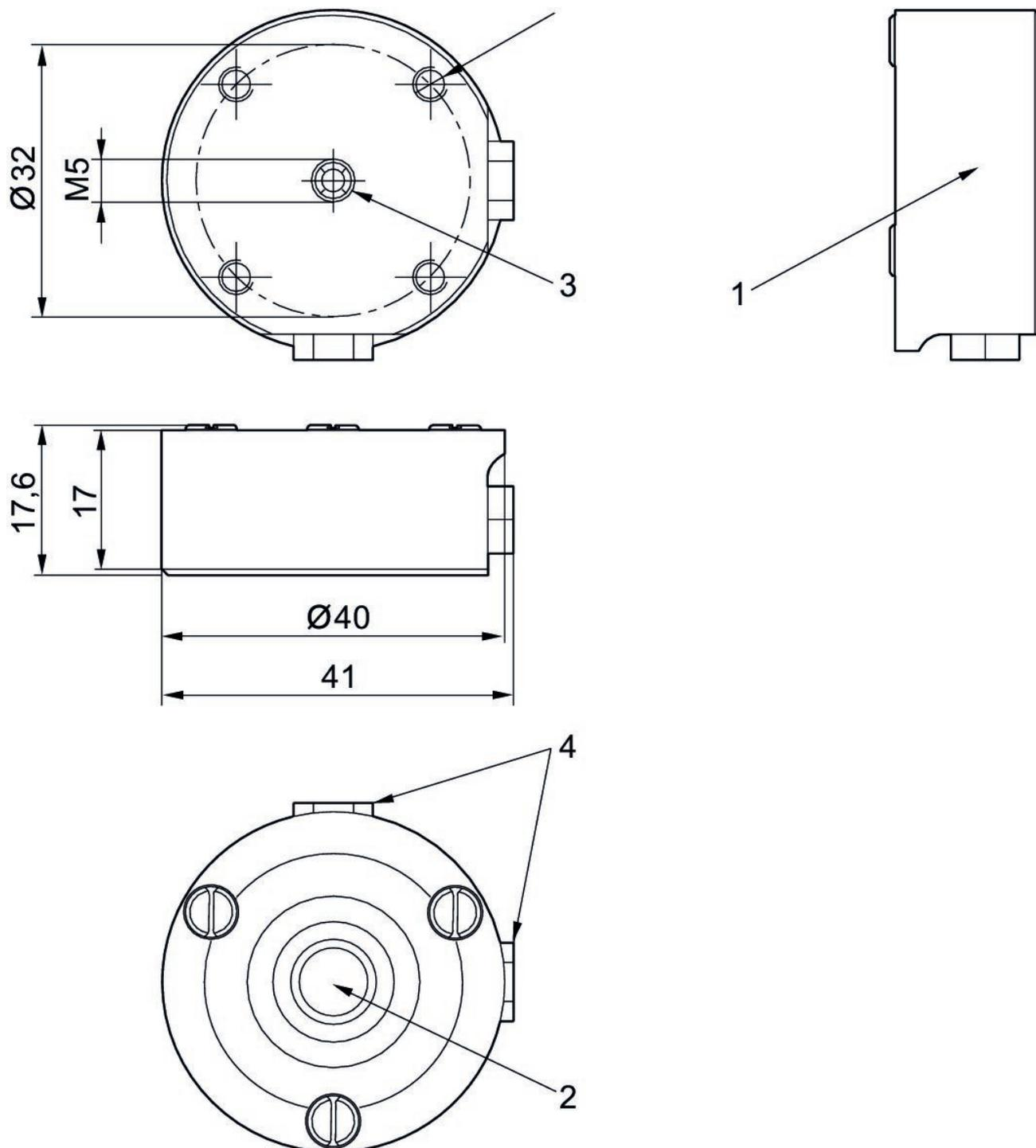
1) 停止 2) ノズル 3) 圧縮空気ポート 4) 封ねじ付きその他の圧縮空気ポート
