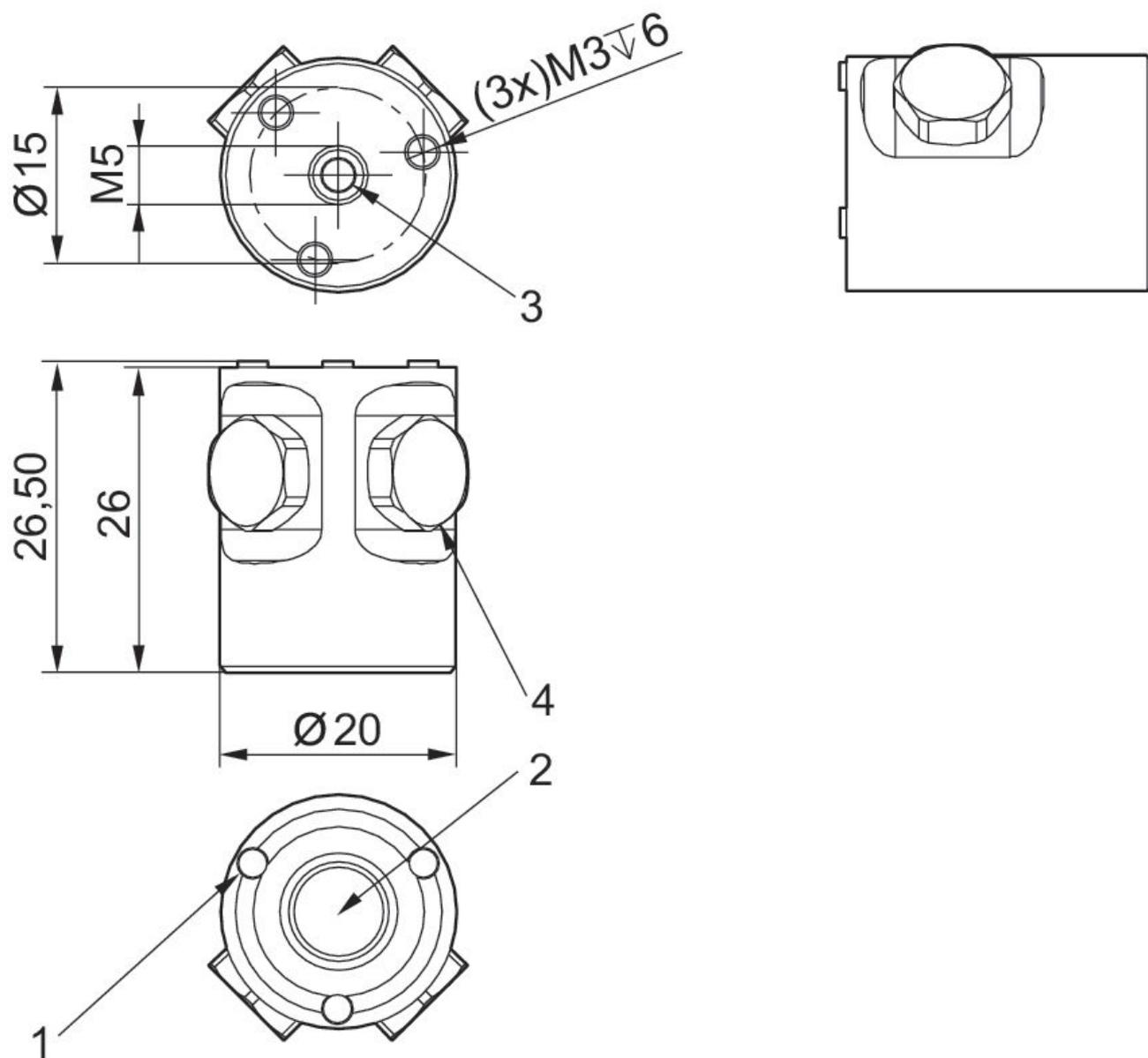
1) 停止 2) ノズル 3) 圧縮空気ポート 4) 封ねじ付きその他の圧縮空気ポート
