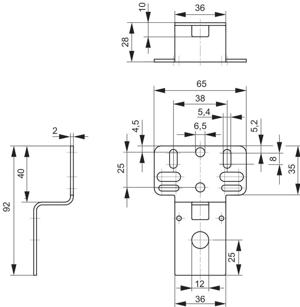
固定プレート W01 を取り付ける際には、メンテナンス装置後方のカバーを取り外す必要があります。
