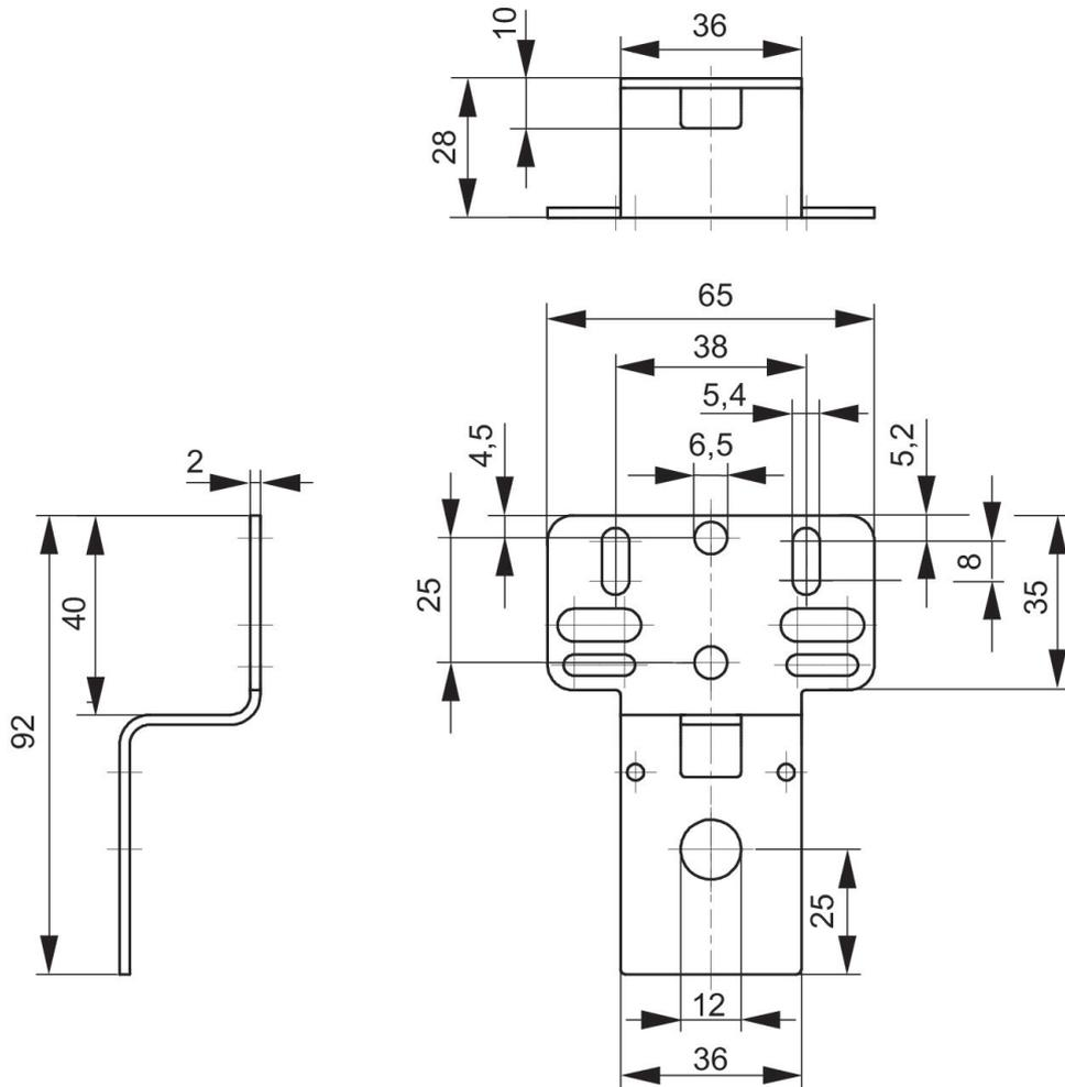
Per il montaggio della piastra di fissaggio W01 occorre rimuovere la copertura posteriore dell'unità di manutenzione.
