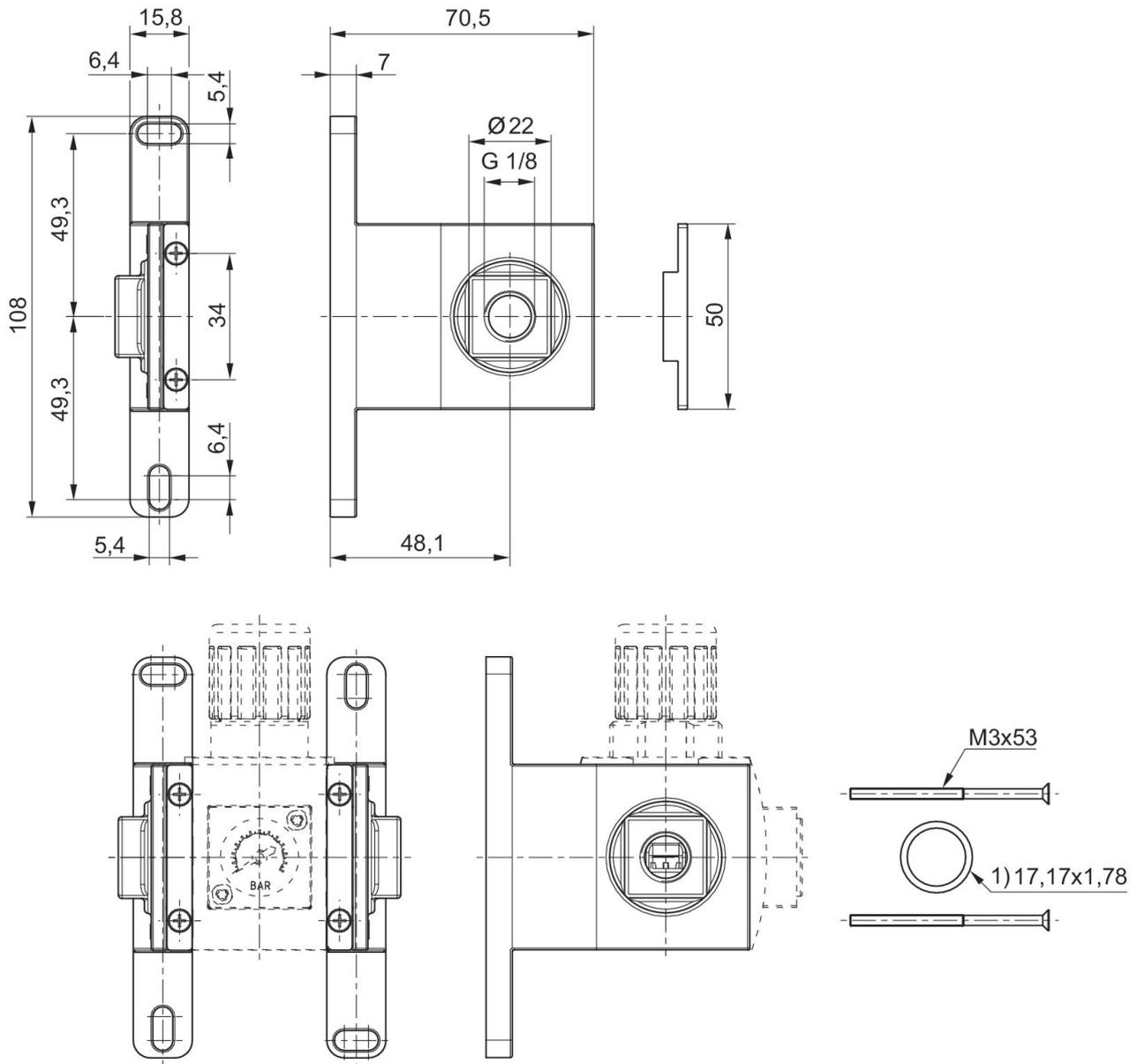
1) Lieferung inkl. 4 Befestigungsschrauben M3x53-4.8-A2R nach EN ISO 7046-1 (Senkschraube mit Kreuzschlitz Form H), 2 x O-Ring
