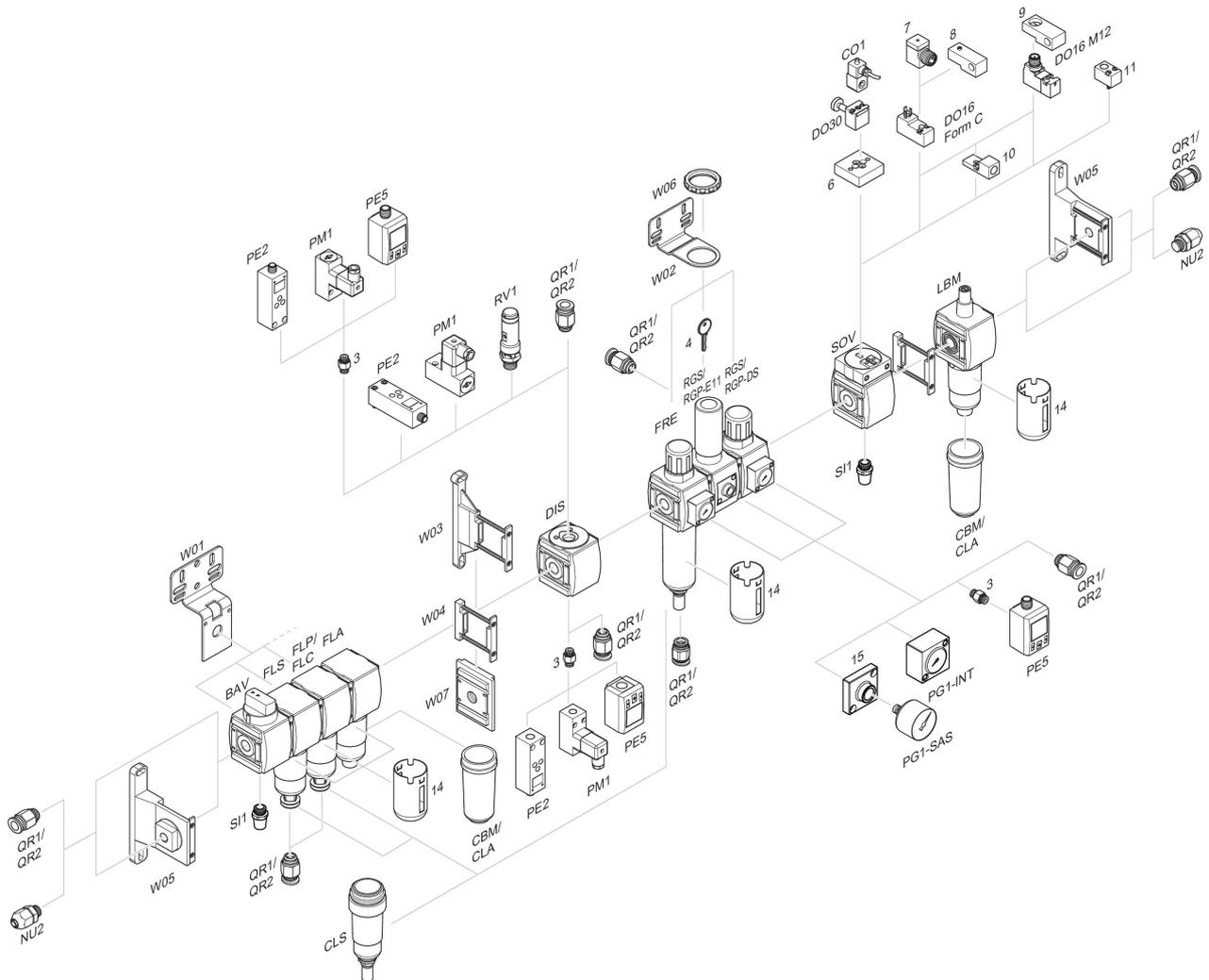
3 = Nipplo doppio 4 = Chiave per chiusura E11 6 = Piastra di adattamento DO30 7 = Adattatore, Serie CON-VP 8 = Dispositivo di montaggio DO16, forma C
