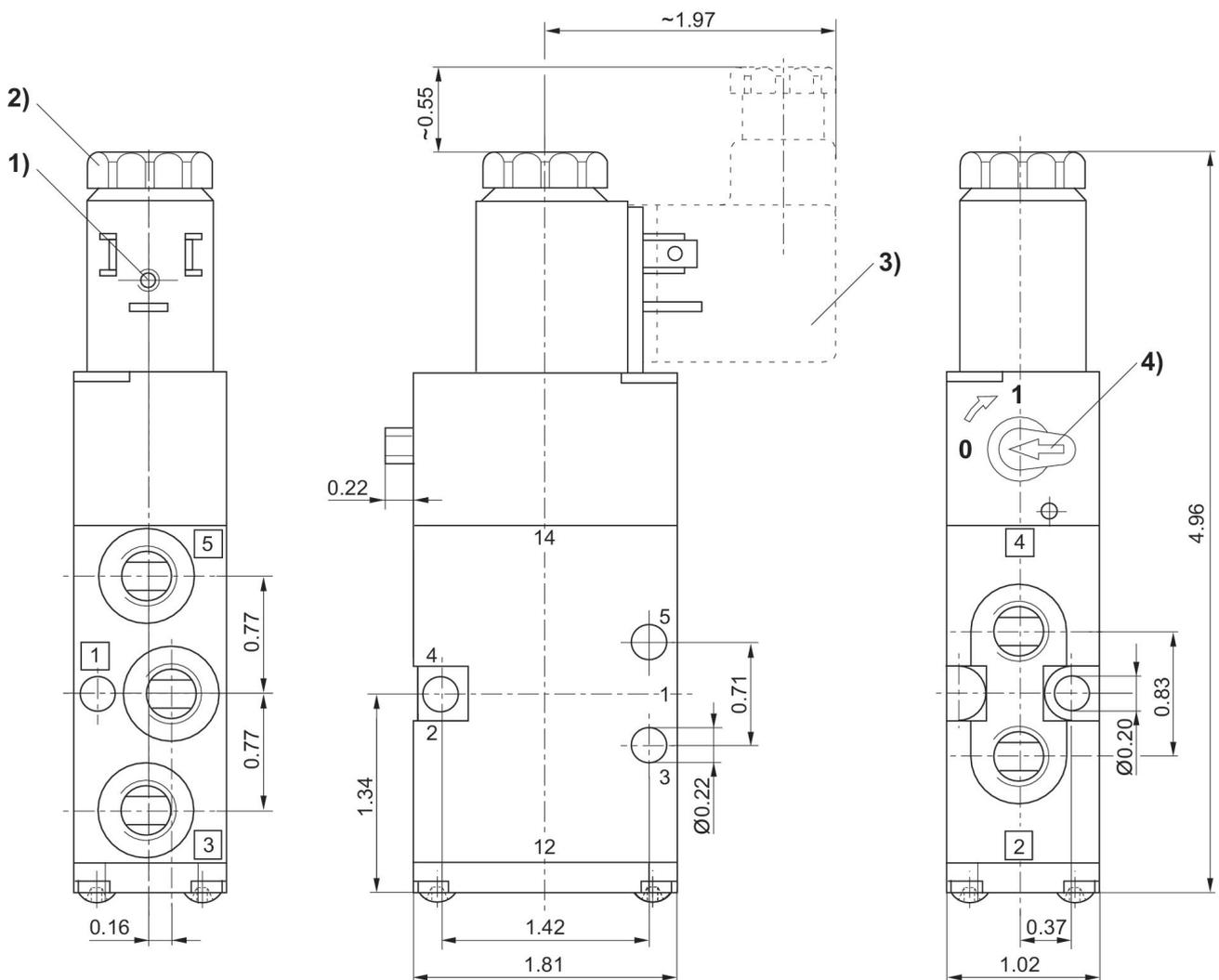
1) bobina orientabile ogni volta di 90°
