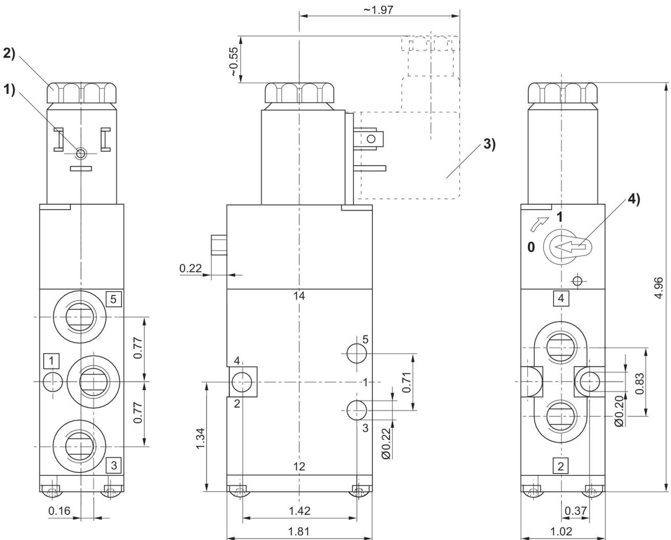
1) Spule um jeweils 90° drehbar 2) nach Entfernen der Kappe Innengewinde M5 3) Ventilsteckverbinder jeweils um 180° steckbar 4) Handhilfsbetätigung
