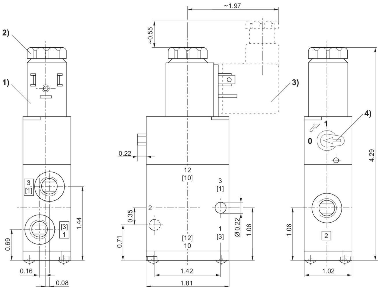
1) bobina orientabile ogni volta di 90°
