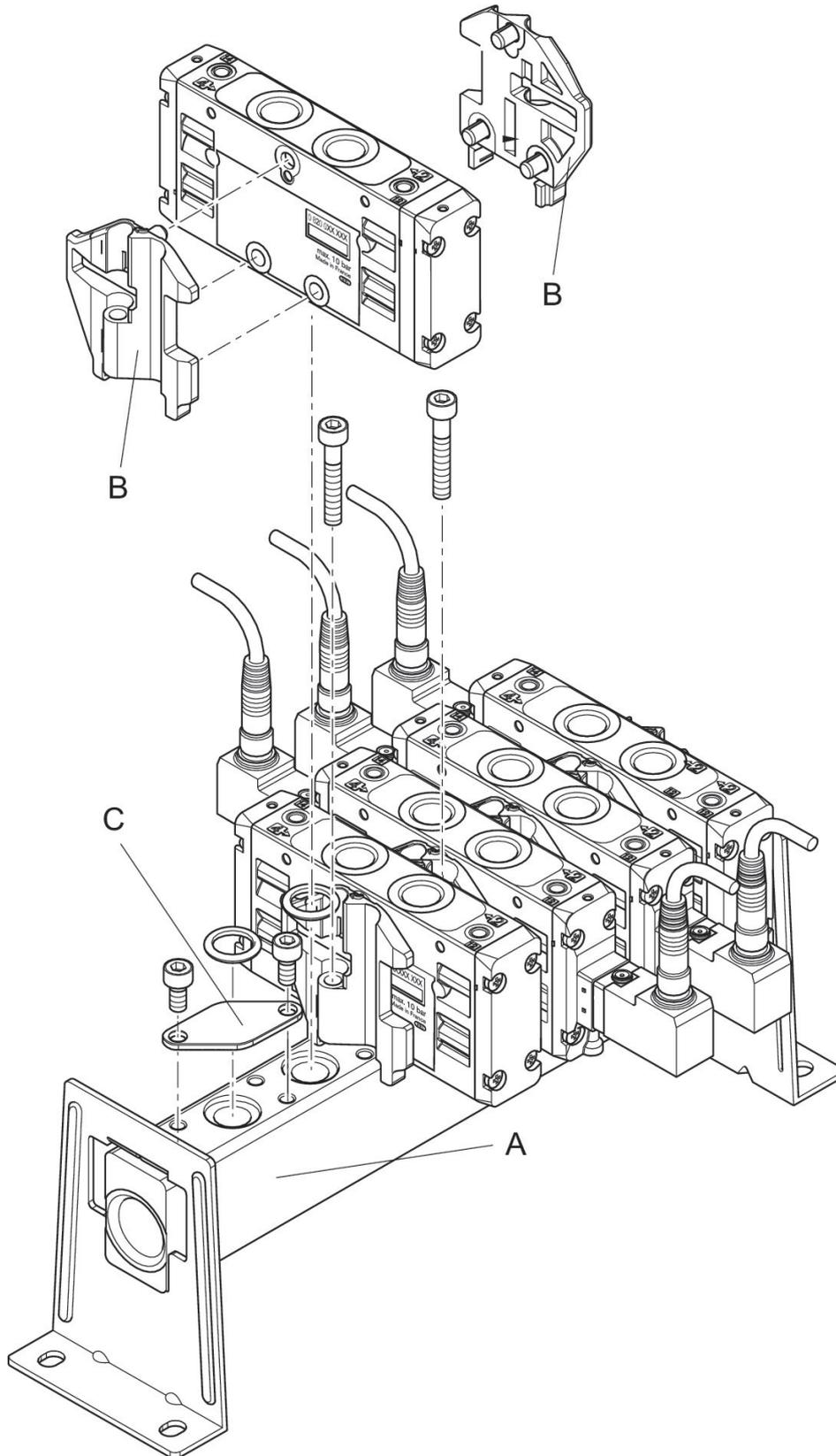
Pour le montage des distributeurs, il faut commander : l'embase multiple A et le kit de fixation B
