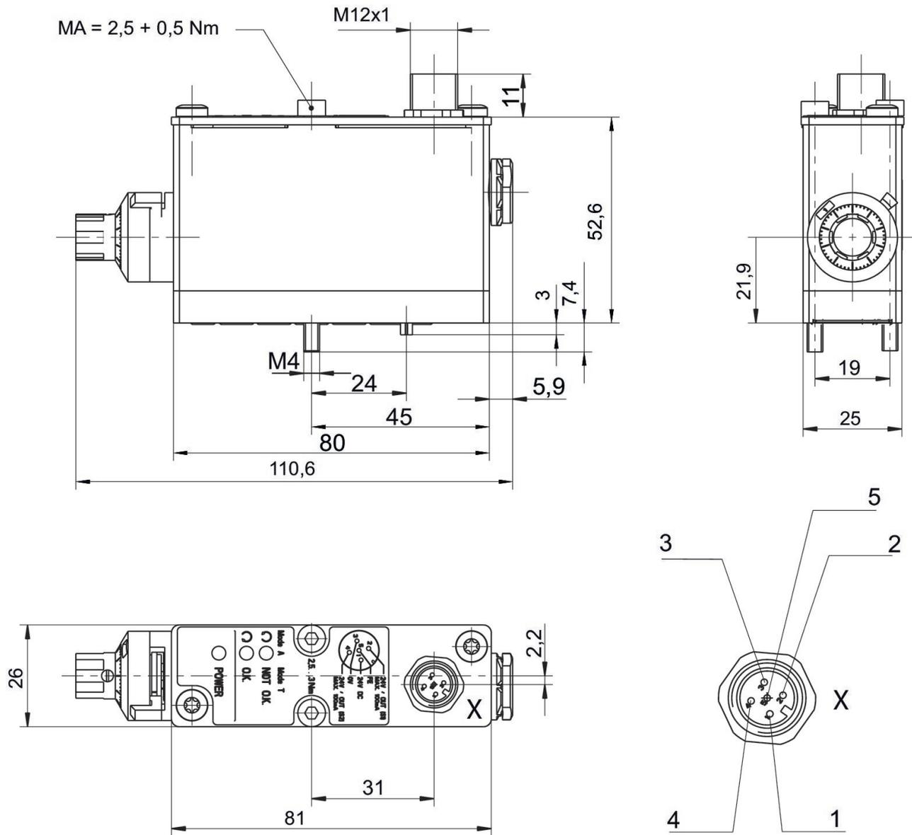
schema dei contatti M12: Contatto 1: 24 V DC Contatto 2: segnale di uscita 24 V DC, S1 (pressione di esercizio), max. 100 mA Contatto 3: 0 V Contatto 4: segnale di uscita 24 V DC, S2 (verifica), max. 100 mA Contatto 5: FE
