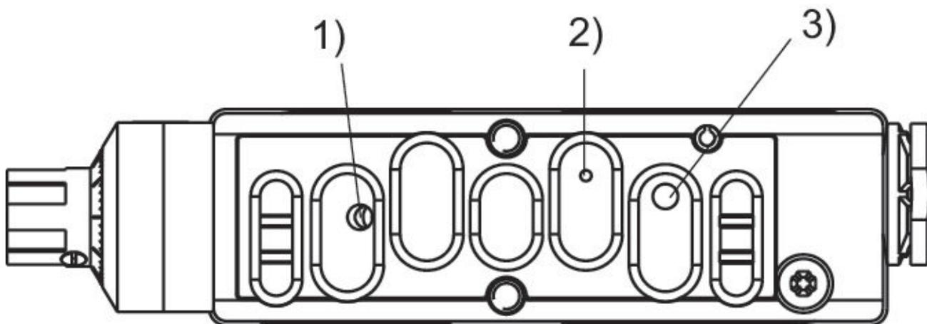
Utilisable pour plaque de base avec gabarit de perçage selon ISO 15407-1 1 = pression de contrôle 2 = buse de raccordement 3 = pression de l'air libre
