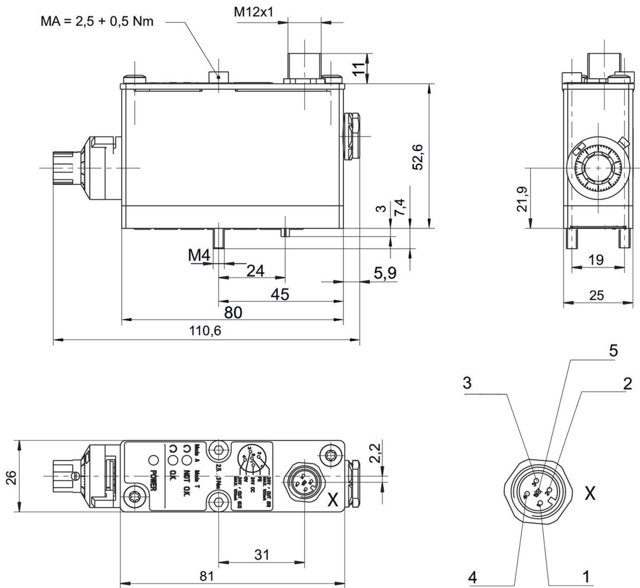
M12 affectation des contacts : Contact 1 : 24 V CC Contact 2 : signal de sortie 24 V CC, S1 (pression de service), max. 100 mA Contact 3 : 0 V Contact 4 : signal de sortie 24 V CC, S2 (contrôler), max. 100 mA Contact 5 : FE
