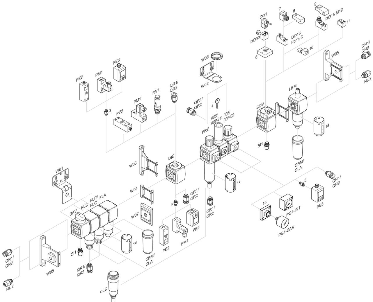
3 = Boquilla doble 4 = Llave para cierre E11 6 = Placa adaptadora DO30 7 = Adaptador, Serie CON-VP 8 = Ayuda de montaje DO16, forma C 9 = Ayuda de montaje DO16, M12 10 = Adaptador, aire de pilotaje externo 11 = Adaptador acción neumática 14 = Cesta de protección 15 = Placa adaptadora para montaje del manómetro con conexión roscada G 1/8
