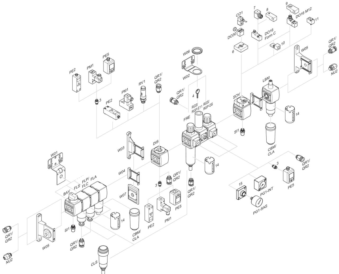
3 = Doppelnippel 4 = Schlüssel für E11-Schließung 6 = Adapterplatte DO30 7 = Adapter, Serie CON-VP 8 = Montagehilfe DO16, Form C 9 = Montagehilfe DO16, M12 10 = Adapter externe Steuerluft 11 = Adapter pneumatische Betätigung 14 = Schutzkorb 15 = Adapterplatte zur Montage eines Manometers mit Anschlussgewinde G 1/8
