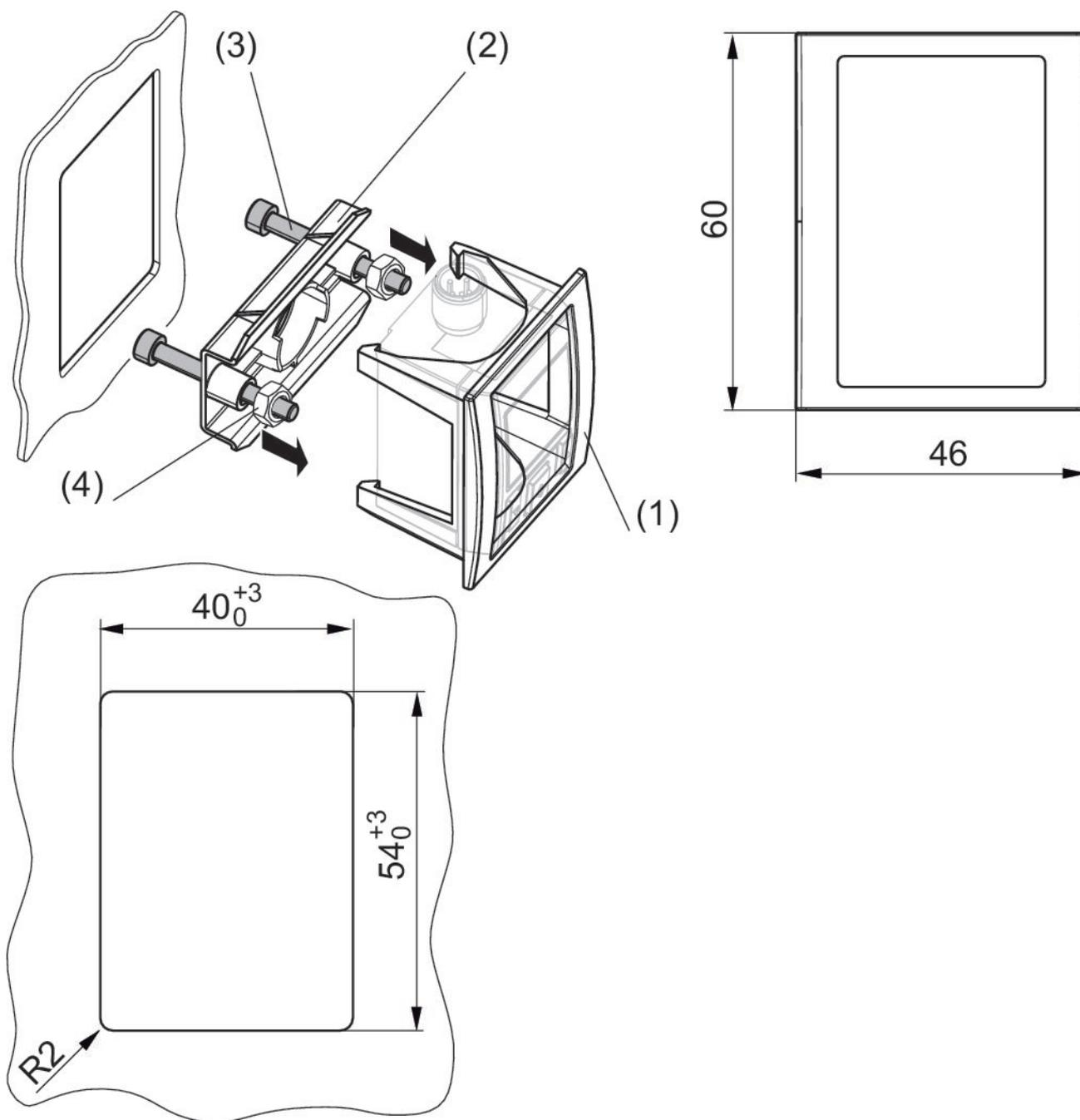
1 个前框架 (1), 1 个壁挂式安装件 (2), 2 个安装螺栓 M4x40 (3), 2 个六角螺母 (4)
