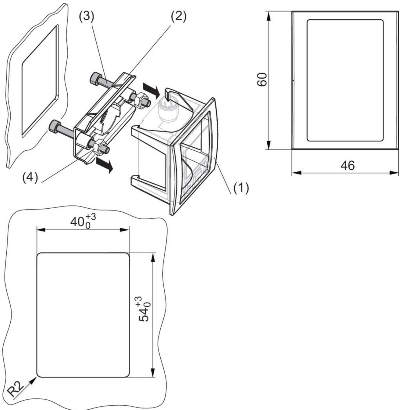
1 armação dianteira (1), 1 peça de montagem na parede (2), 2 parafusos de fixação M4x40 (3), 2 porcas com sextavado (4)
