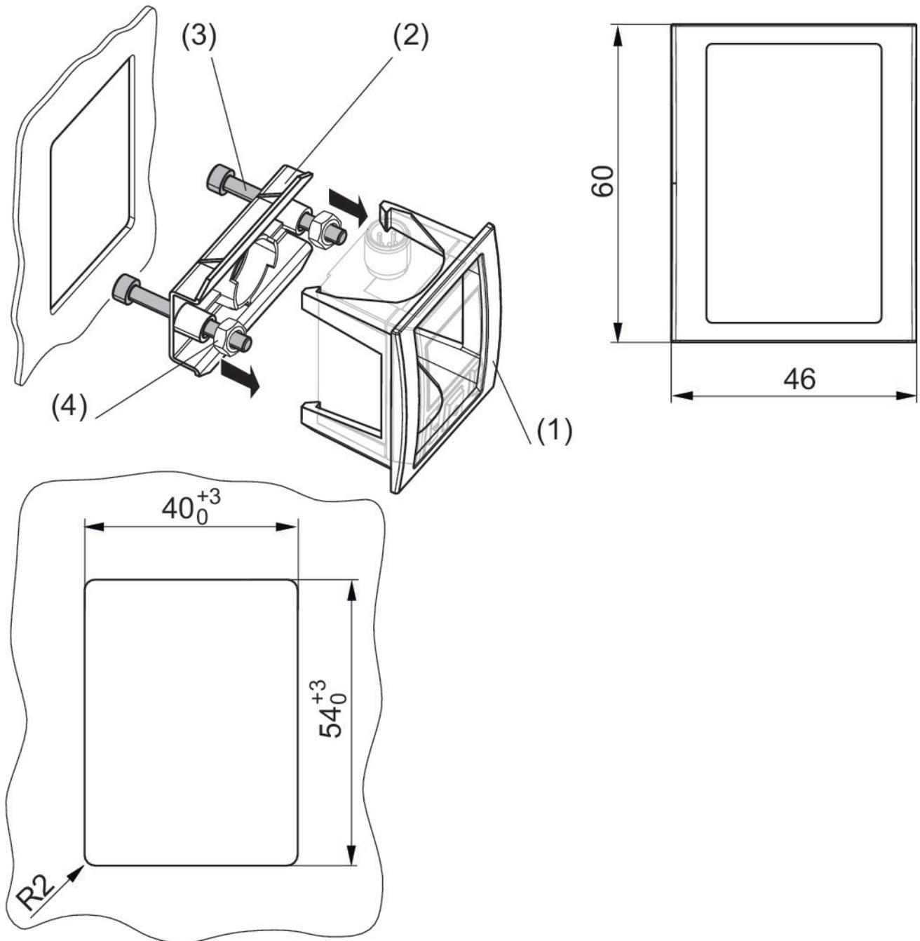
1 telaio frontale (1), 1 fissaggio a parete (2), 2 viti di fissaggio M4x40 (3), 2 dadi esagonali (4)
