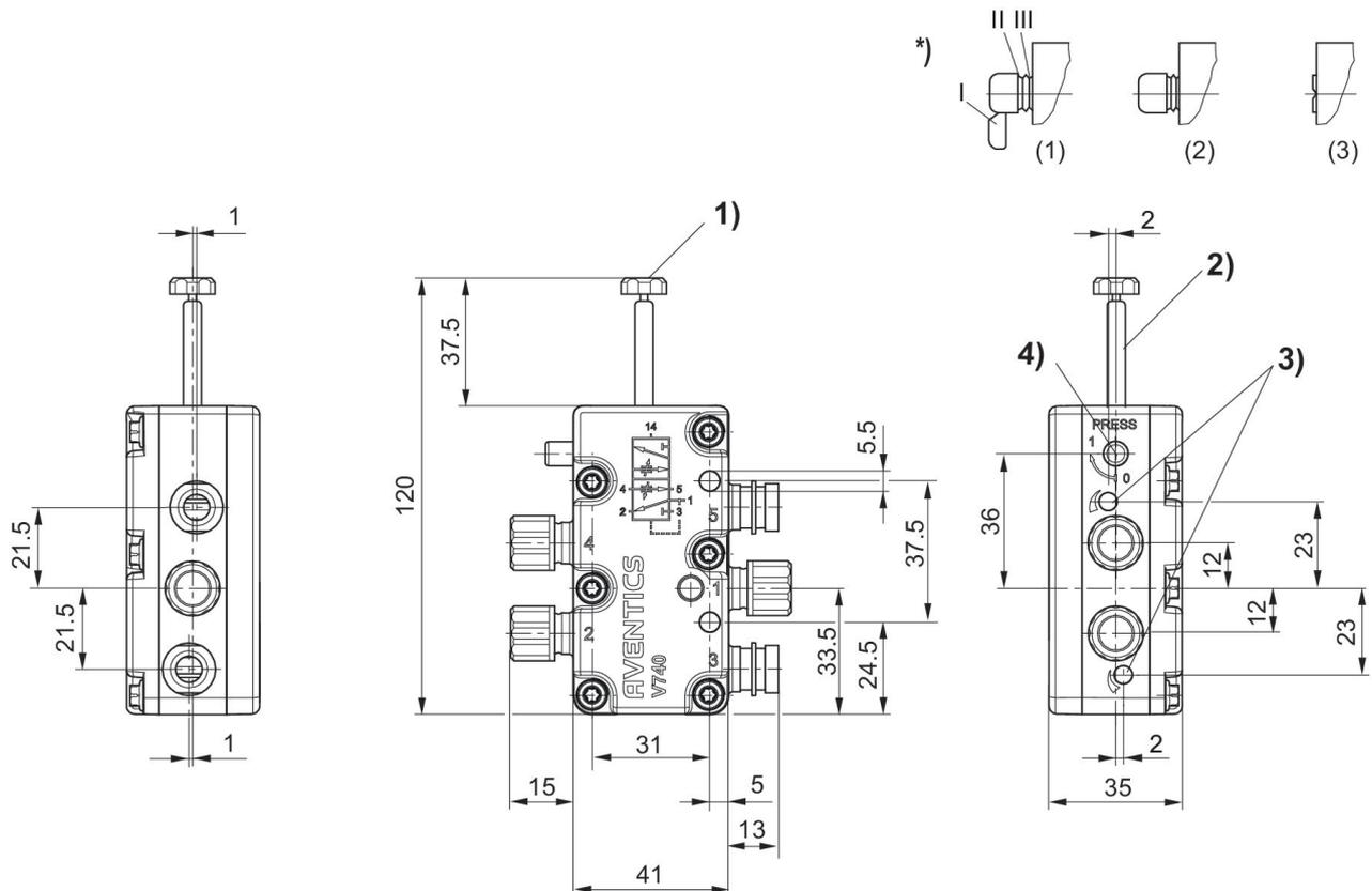
1) rosca interior M5 2) bobina enchufable 45° 3) tornillo de estrangulación para los escapes 5 (R) y 3 (S) 4) accionamiento auxiliar manual e indicación de posición \*) : accionamiento auxiliar manual: accionamiento a mano: (1) encajable - presionar y girar en la posición 1 (2) no encajable - separar el segmento I - sólo presionar accionamiento mediante herramienta: (3) encajable - separar segmentos hasta III, presionar con herramienta y girar en la posición 1
