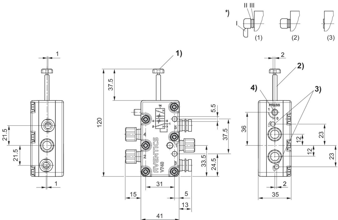
1) Filettatura interna M5 2) Bobina inseribile ogni volta di 45° 3) Vite di strozzamento per gli scarichi 5 (R) e 3 (S) 4) Azionamento manuale ed indicatore di posizione \*) : Azionamento manuale: Comando a mano: (1) Ritenzione - premere e ruotare in posizione 1 (2) senza ritenzione - separare il segmento I - premere solamente Azionamento tramite utensile: (3) Ritenzione - separare i segmenti fino al III, premere con l'utensile e ruotare in posizione 1
