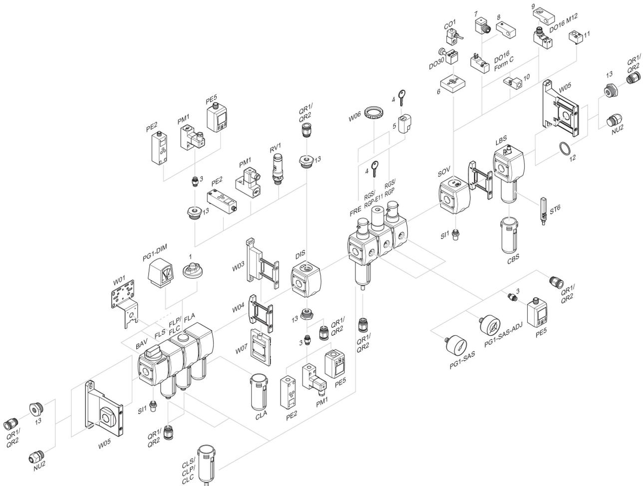
1 = Verschmutzungsanzeige 3 = Doppelnippel 4 = Schlüssel für E11-Schließung 5 = Einsteckschloss 6 = Adapterplatte DO30 7 = Adapter, Serie CON-VP 8 = Montagehilfe DO16, Form C 9 = Montagehilfe DO16, M12 10 = Adapter externe Steuerluft 11 = Adapter pneumatische Betätigung 12 = Dichtring 13 = Reduziernippel
