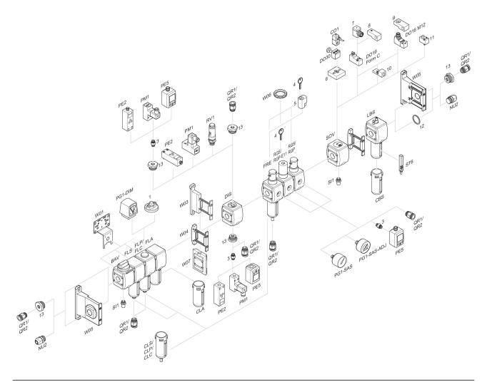
1 = 汚れ表示 3 = ダブルニップル 4 = E11 ロック用キー 5 = 彫り込み型箱鍵 6 = アダプタープレート DO30 7 = アダプター, シリーズ CON-VP 8 = 取付け器 具 DO16, 型C 9 = 取付け器具 DO16, M12 10 = 外部パイロットエアに適しています 11 = アダプター 空圧作動 12 = 封リング 13 = 縮小ニップル
