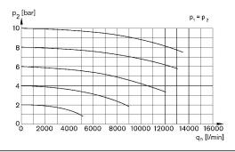
p1 = 作動圧力 p2 = 二次圧力 qn = 定格吐出
