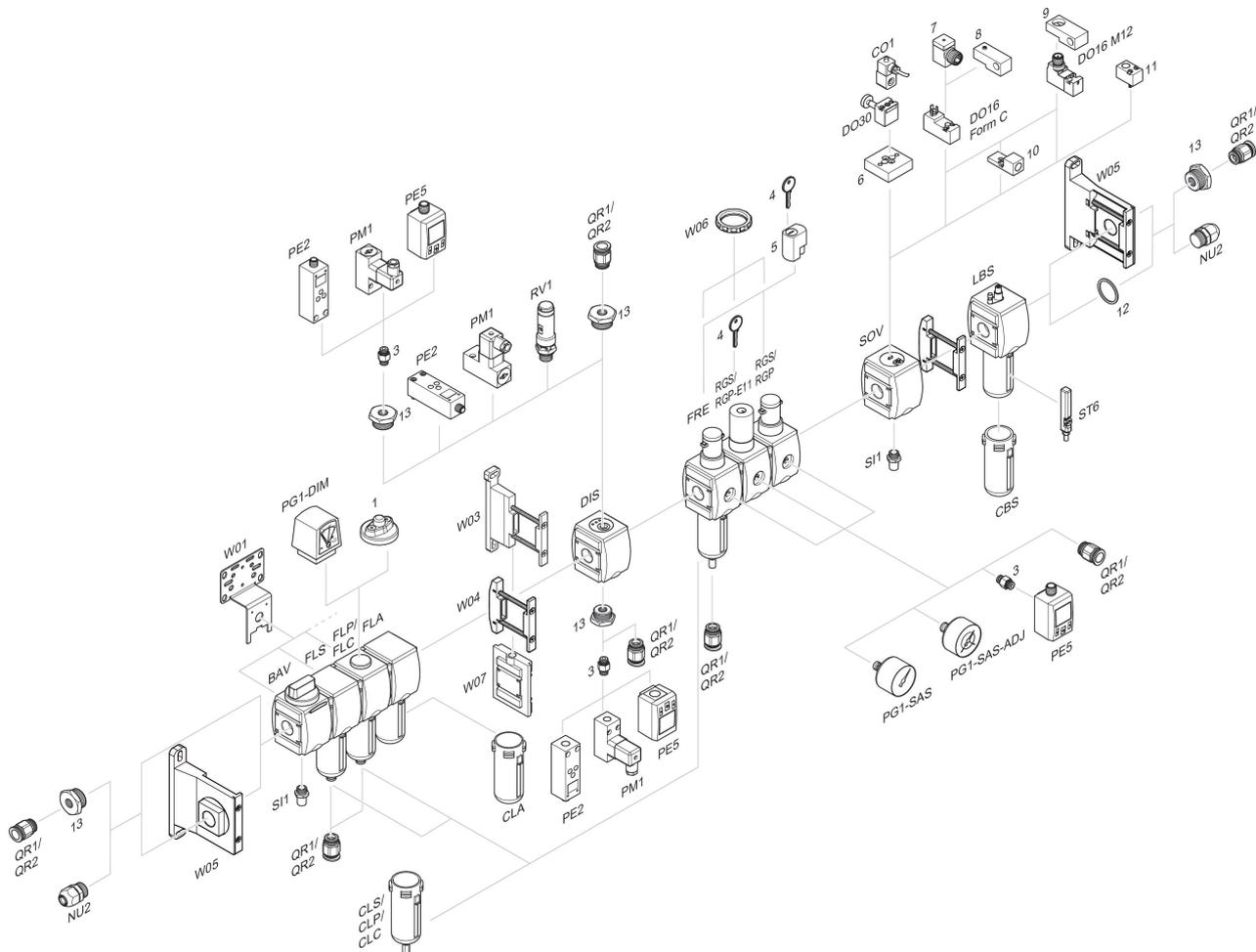
1 = Verschmutzungsanzeige 3 = Doppelnippel 4 = Schlüssel für E11-Schließung 5 = Einsteckschloss 6 = Adapterplatte DO30 7 = Adapter, Serie CON-VP
