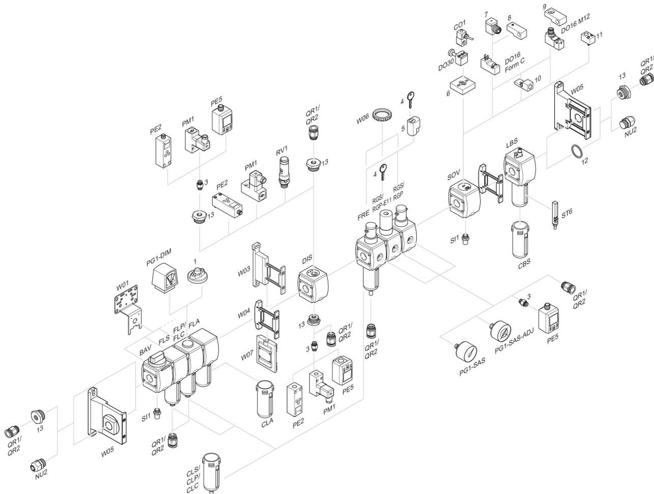
1 = Indicador de sujeira 3 = Niple duplo 4 = Chave para fechamento E11 5 = fechadura de embutir 6 = Placa adaptadora DO30 7 = Adaptador, Série CON-VP 8 = Auxiliar de montagem DO16, formato C 9 = Auxiliar de montagem DO16, M12 10 = Adaptador de ar de comando externo 11 = Adaptador de acionamento pneumático 12 = Anel de vedação 13 = Niple de redução
