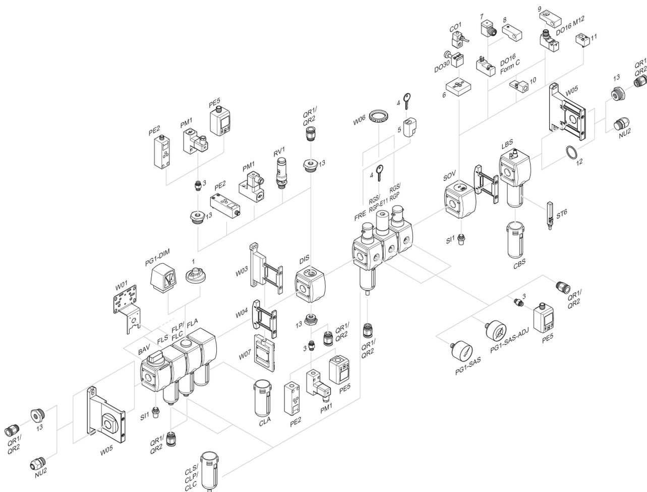
1 = Indicatore di sporco 3 = Nipplo doppio 4 = Chiave per chiusura E11 5 = serratura ad innesto 6 = Piastra di adattamento DO30 7 = Adattatore, Serie CON-VP 8 = Dispositivo di montaggio DO16, forma C 9 = Dispositivo di montaggio DO16, M12 10 = Adattatore aria di pilotaggio esterna 11 = Adattatore azionamento pneumatico 12 = Anello di tenuta 13 = Nipplo di riduzione
