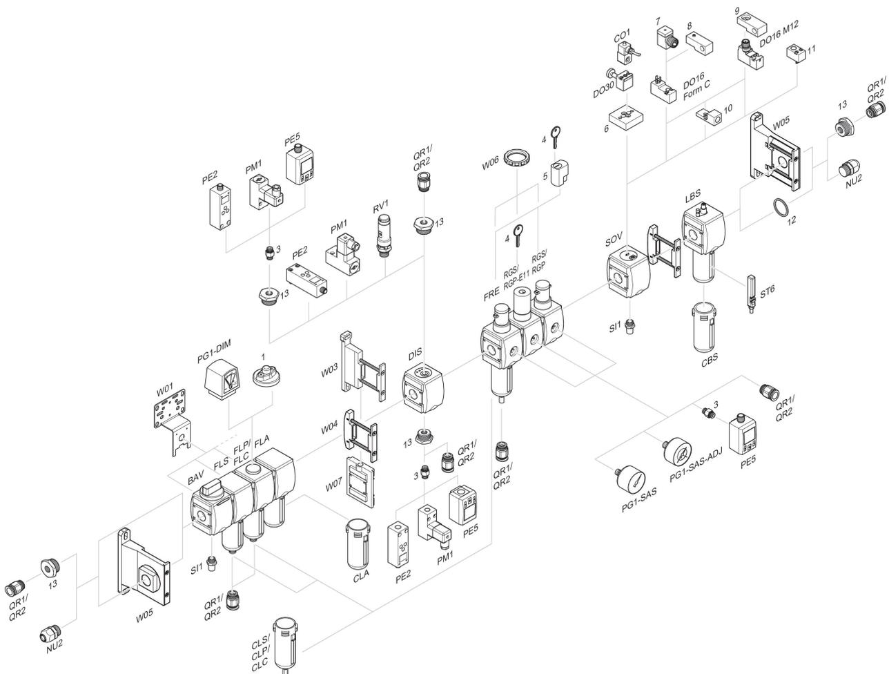
1 = Indicador de suciedad 3 = Boquilla doble 4 = Llave para cierre E11 5 = cerradura empotrable 6 = Placa adaptadora DO30 7 = Adaptador, Serie CON-VP 8 = Ayuda de montaje DO16, forma C 9 = Ayuda de montaje DO16, M12 10 = Adaptador, aire de pilotaje externo 11 = Adaptador acción neumática 12 = Anillo obturador 13 = Boquilla de reducción
