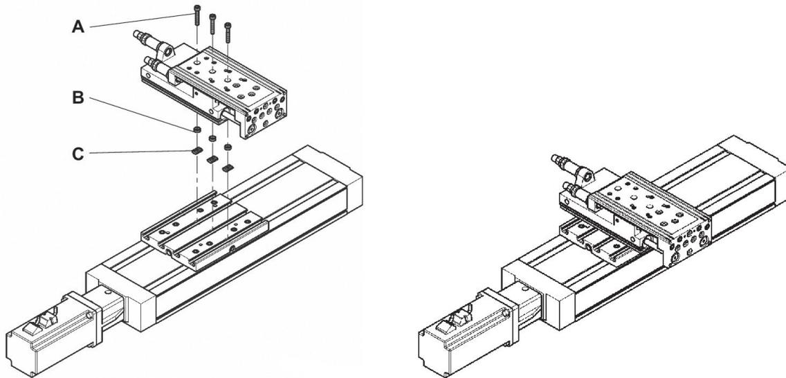
Fourniture : A) Vis B) Douilles de centrage C) Écrous de fixation
