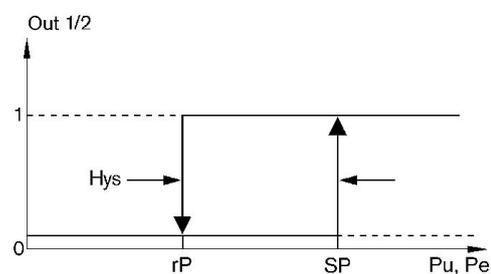
SP = point d'enclenchement, rP = point de commutation vers un niveau inférieur
