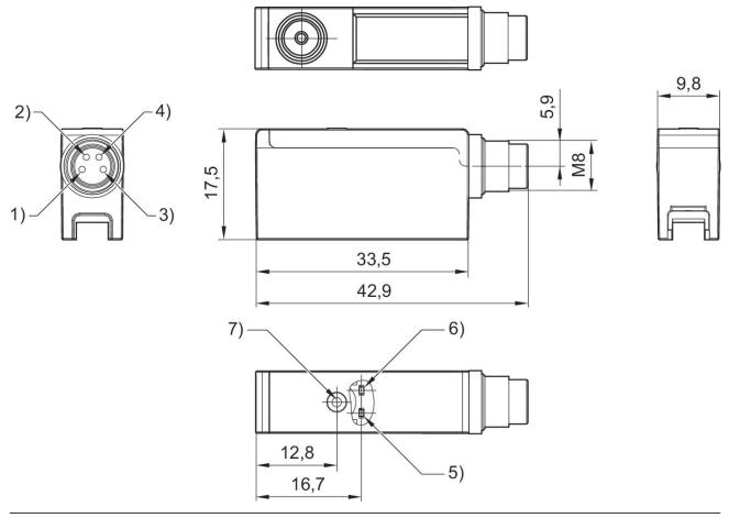
1) +UB 2) Switch output 2 3) GND 4) Switch output 1 5) LED for switch output 2 6) LED for switch output 1 7) setting knob
