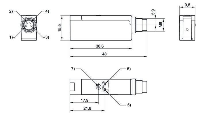
1) +UB 2) Switch output 2 3) GND 4) Switch output 1 5) LED for switch output 2 6) LED for switch output 1 7) setting knob
