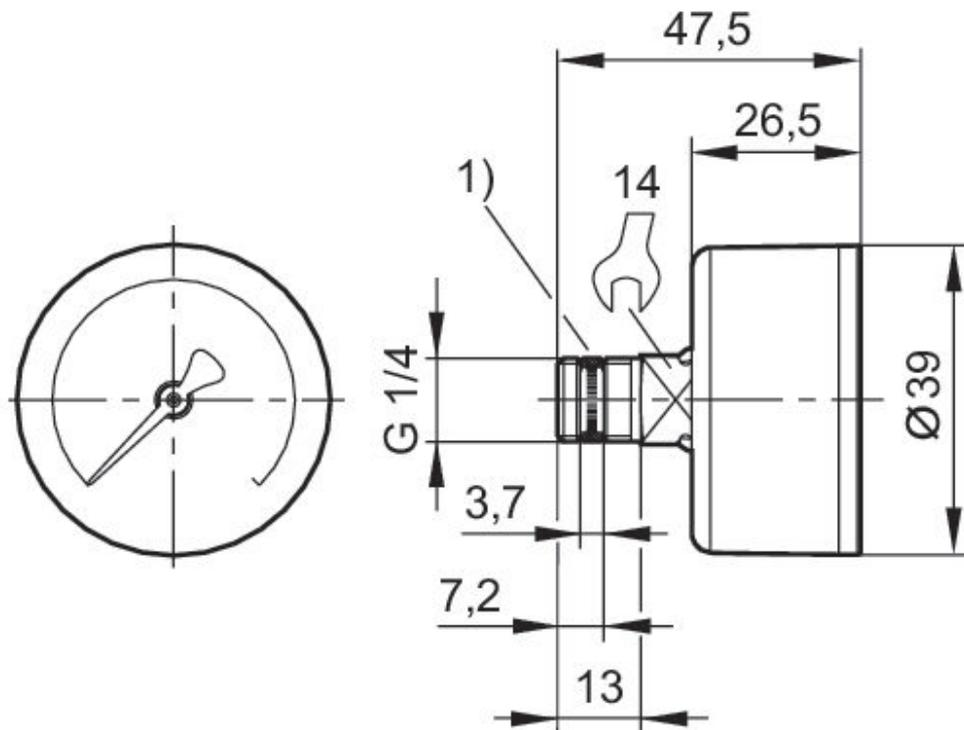
1) montierte Dichtung
