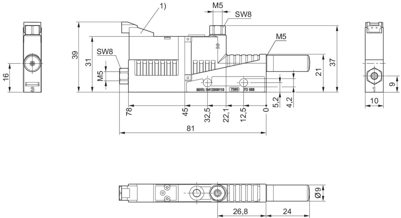
1) Válvula de accionamiento eléctrico vacío conectado/desconectado
