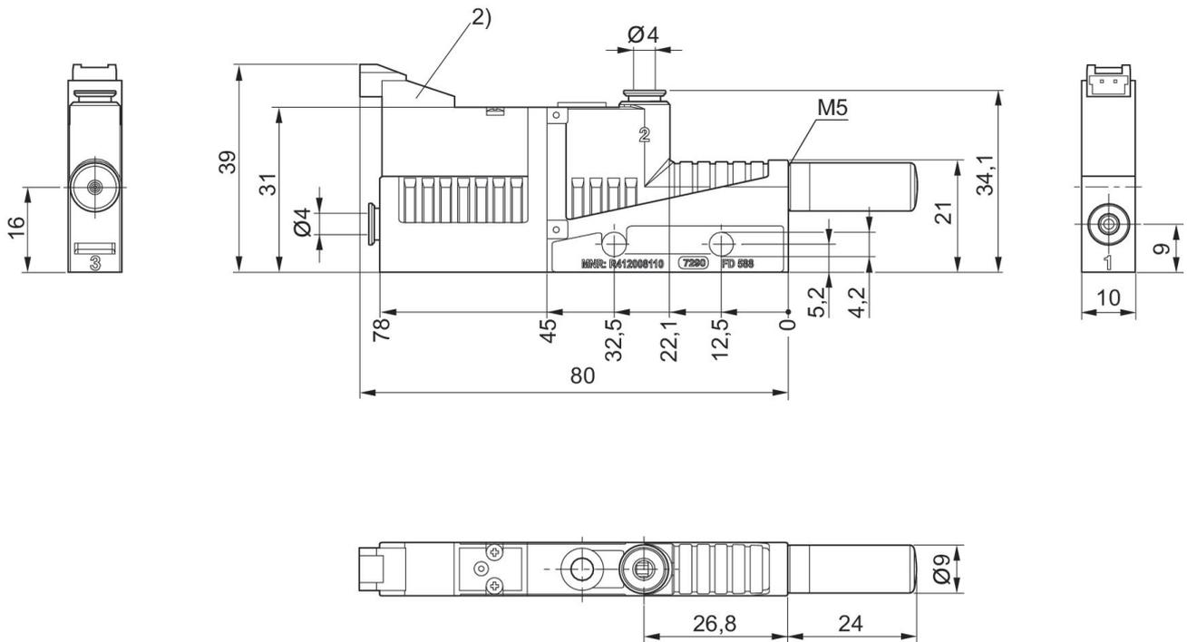
2) Válvula de accionamiento eléctrico vacío conectado/desconectado
