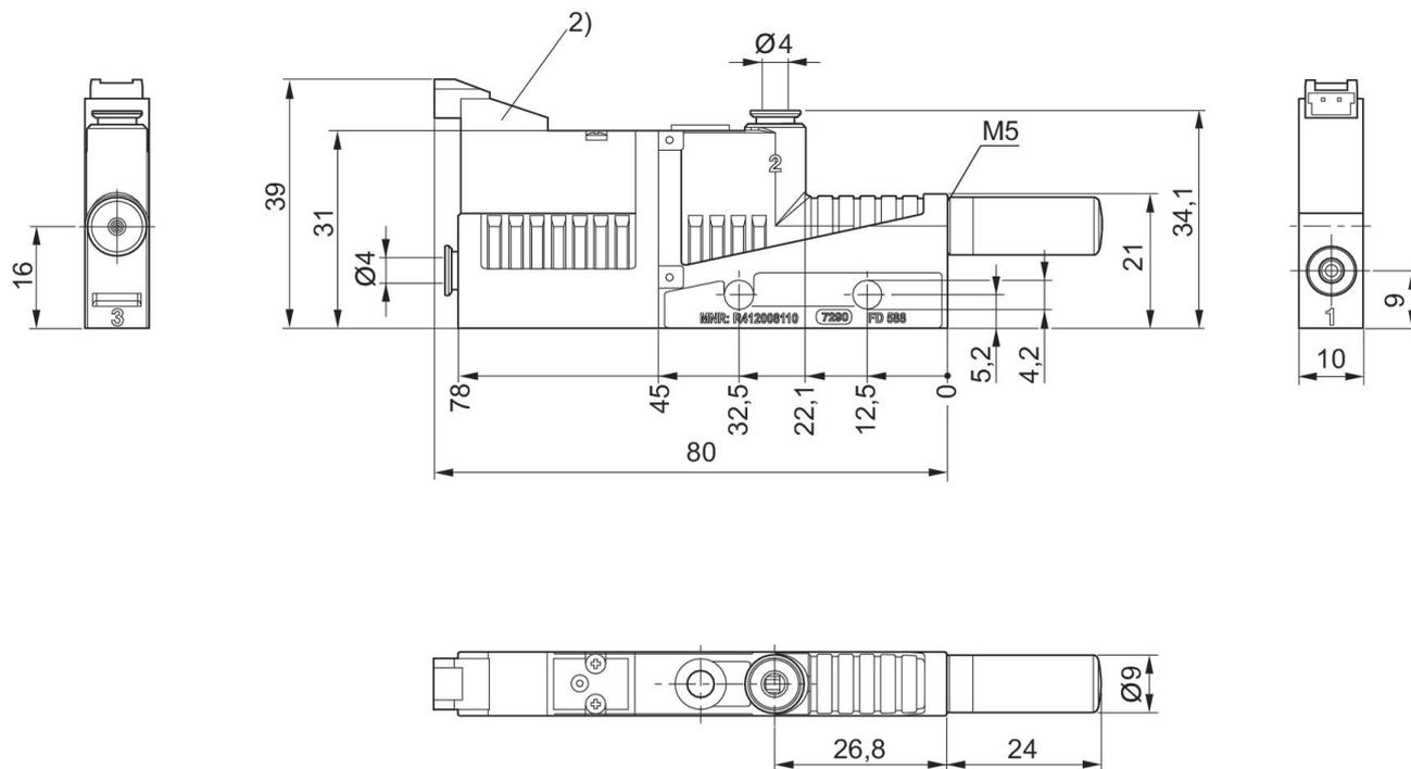
2) Magnetventil Vakuum EIN/AUS
