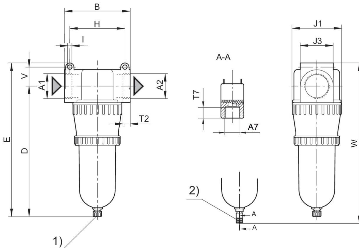
1) Manueller + halbautomatischer Kondensatablass 2) Vollautomatischer Kondensatablass
