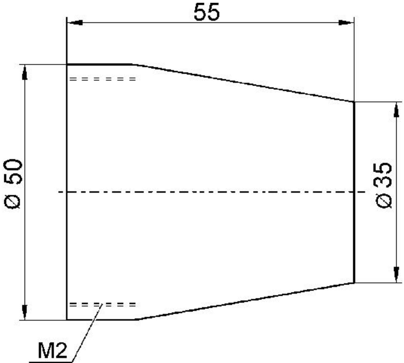
保護キャップはカップリングのいずれの端につけても結構です。
