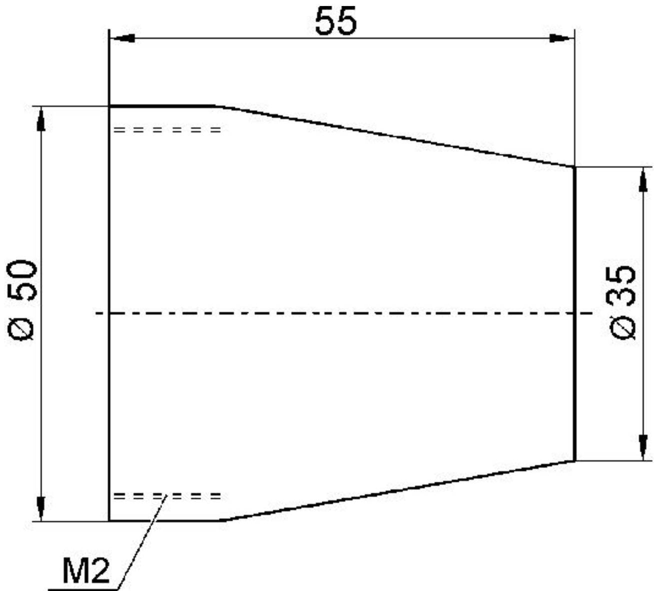
Die Schutzkappe ist auf beiden Seiten der Kupplung montierbar.
