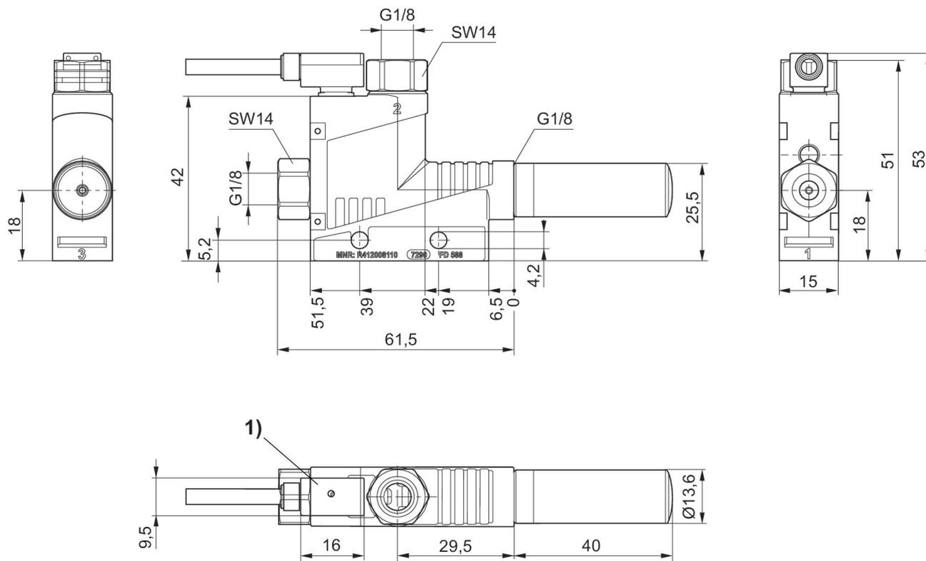
1) il vacuostato è ruotabile, non è sostituibile
