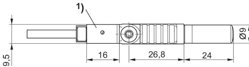
1) il vacuostato è ruotabile, non è sostituibile
