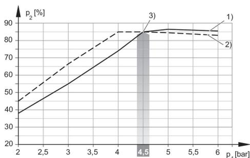
1) =  $\varnothing$  ugello 1,0 mm 2) =  $\varnothing$  ugello 1,5 mm
