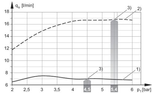
1) = Ø buse 0,5 mm 2) = Ø buse 0,7 mm
