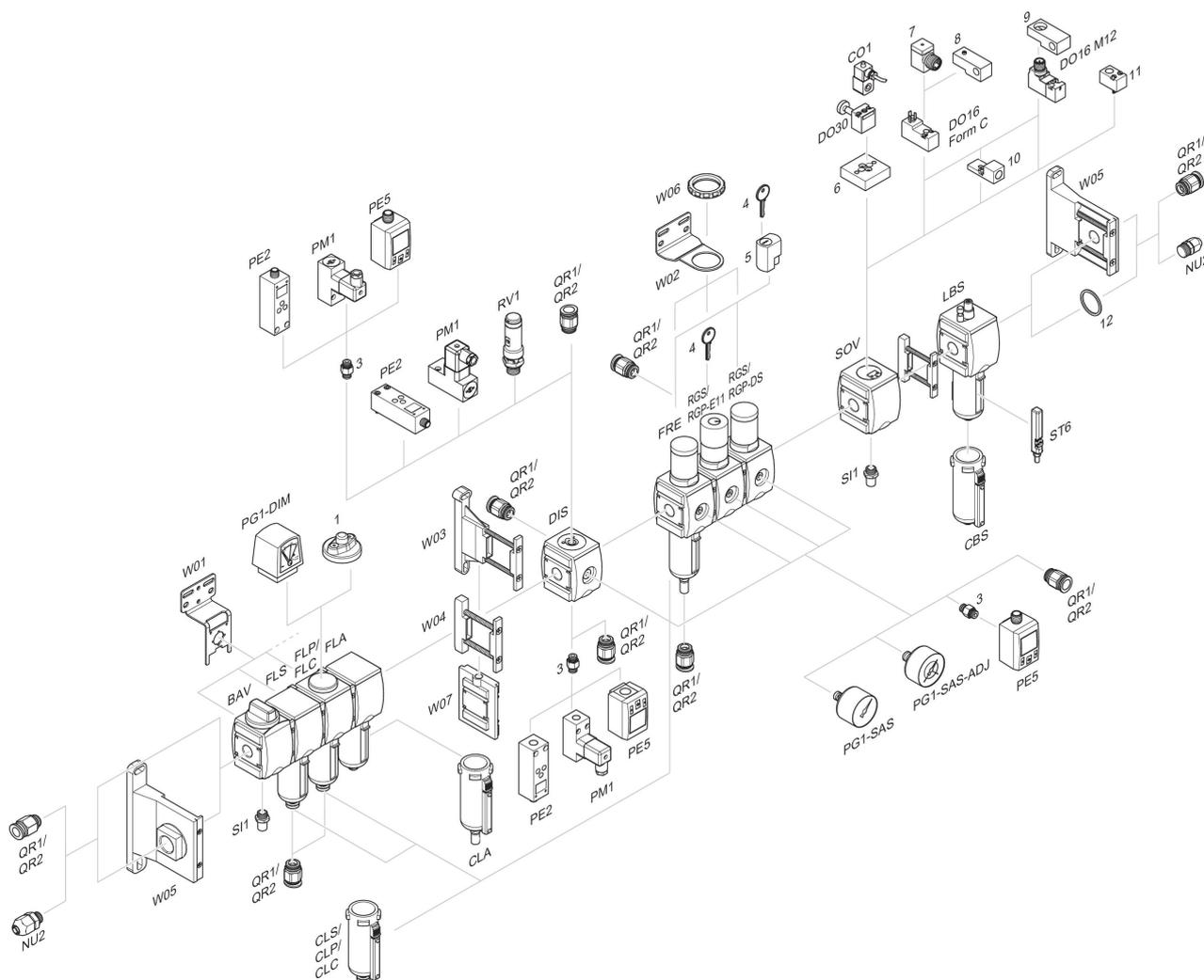
1 = Indicador de suciedad 3 = Boquilla doble 4 = Llave para cierre E11 5 = cerradura empotrable 6 = Placa adaptadora DO30 7 = Adaptador, Serie CON-VP 8 = Ayuda de montaje DO16, forma C 9 = Ayuda de montaje DO16, M12 10 = Adaptador, aire de pilotaje externo 11 = Adaptador acción neumática 12 = Anillo obturador
