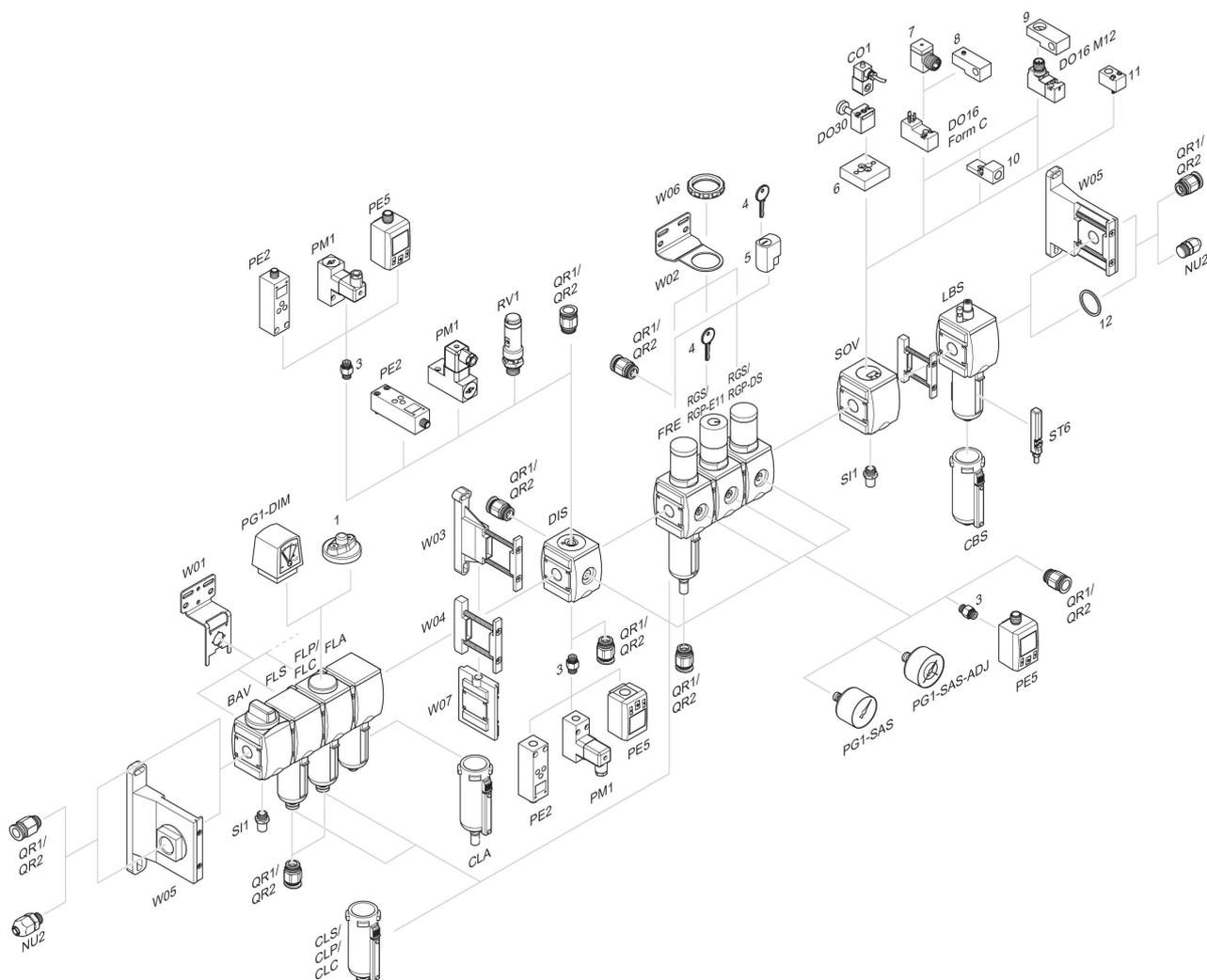
1 = Indicatore di sporco 3 = Nipplo doppio 4 = Chiave per chiusura E11 5 = serratura ad innesto 6 = Piastra di adattamento DO30 7 = Adattatore, Serie CON-VP 8 = Dispositivo di montaggio DO16, forma C 9 = Dispositivo di montaggio DO16, M12 10 = Adattatore aria di pilotaggio esterna 11 = Adattatore azionamento pneumatico 12 = Anello di tenuta
