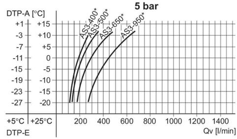
DTP-E: punto de condensación de presión entrada, DTP-A: punto de condensación de presión salida, Qv: caudal de entrada (caudal de salida + aire de barrido).
