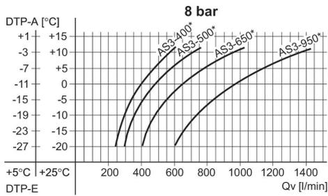
DTP-E: punto de condensación de presión entrada, DTP-A: punto de condensación de presión salida, Qv: caudal de entrada (caudal de salida + aire de barrido).
