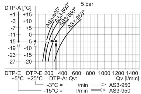
Resultado: secador de membrana AS3-950 (con un Qn de 950 l/min), número de material R412007081
