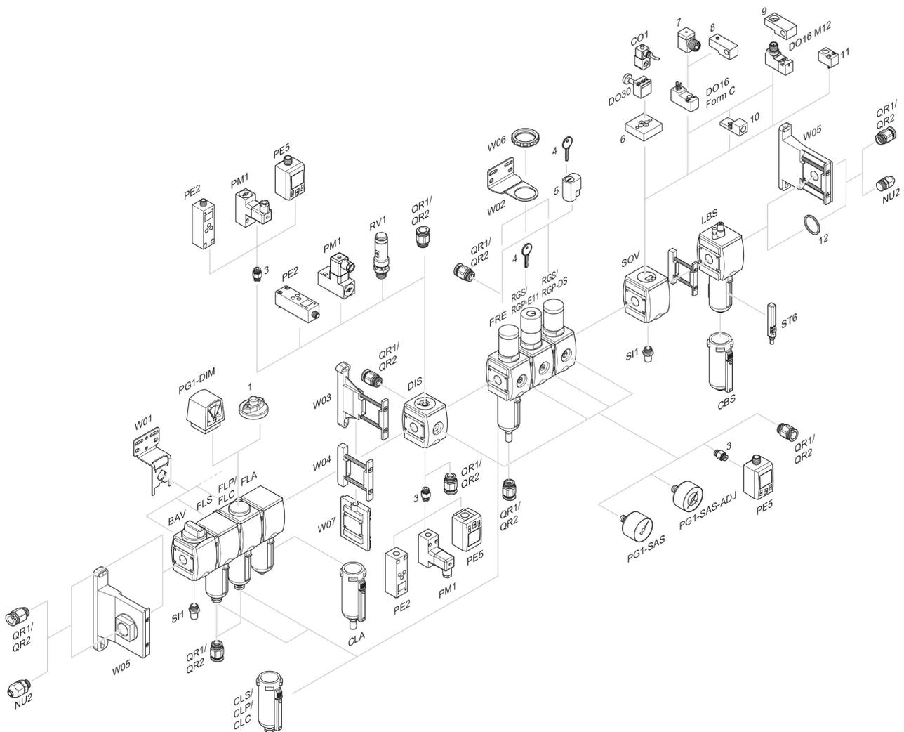
1 = Verschmutzungsanzeige 3 = Doppelnippel 4 = Schlüssel für E11-Schließung 5 = Einsteckschloss 6 = Adapterplatte DO30 7 = Adapter, Serie CON-VP 8 = Montagehilfe DO16, Form C 9 = Montagehilfe DO16, M12 10 = Adapter externe Steuerluft 11 = Adapter pneumatische Betätigung 12 = Dichtring
